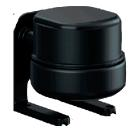
Ayuda a prevenir colisiones bajo el agua, reduciendo la dificultad de operación, hace que varias inspecciones sean más precisas y eficientes. Rango de 0.25 a 5 m, punto ciego de 25 cm, velocidad de respuesta 50m/s, IP68, temperaturas de operación entre -20° a 60° C.
